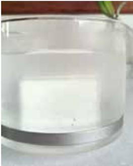
首先，將三個試片裝在同一個玻璃容器中，倒入丙酮溶液，室溫靜置6-12小時。
